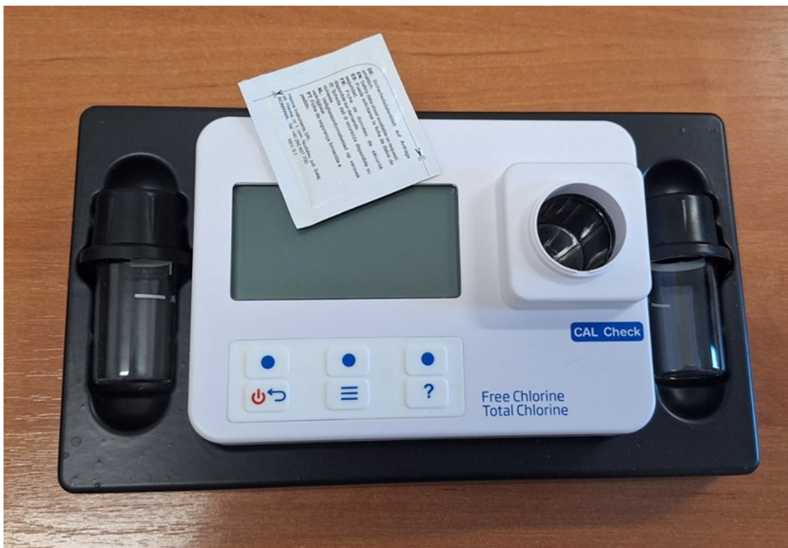
Zdjęcie 3 - Aparat do pomiaru stężenia chloru wolnego w wodzie (zdjęcie własne).
