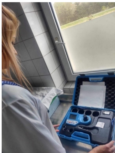
Zdjęcie 1 - Pomiar stężenia chloru wolnego (zdjęcie własne).
